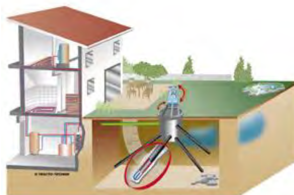
Obr. 1 Bezvýkopová GRD technologie pokládky trubek pro tepelné čerpadlo: systém země – voda.
